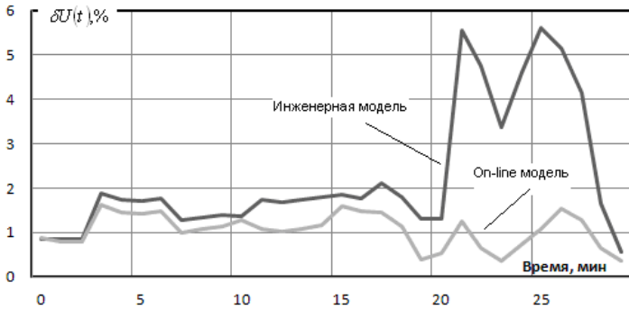
Рис. 12. Погрешности определения модулей напряжения для ОП1
