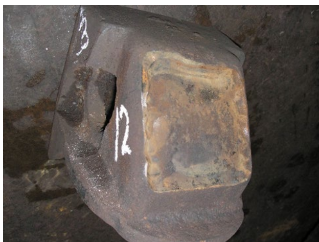
Рис. 3. Износ фрикционных клиньев
